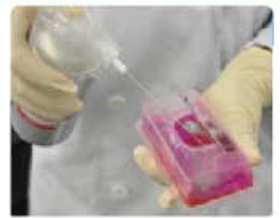
① 検査する部分にスプレー / ② 漏れ検査剤が赤い色に変わると漏れ検査完了
