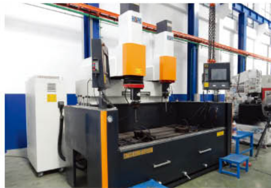
高速かつ高精度を実現する放電加工機
