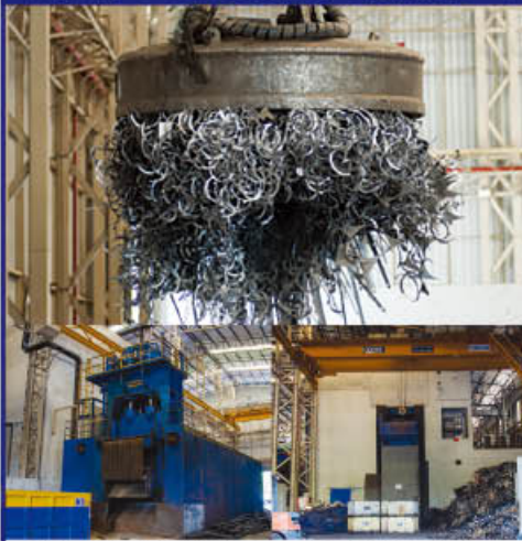
大型の金属くず向け破断機、通称「キロトン」 金属くずを破砕するシュレッダー。
