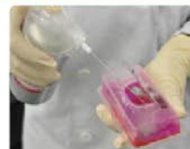
① 検査する部分にスプレー / ② 漏れを確認する部分にスプレー
