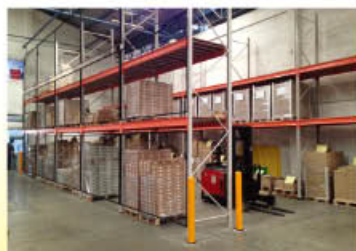
重量ラック(通路幅3M)
