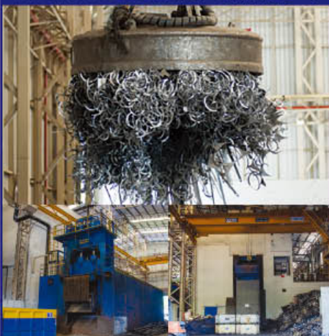
大型の金属くず向け旋削機・選別機(ギロチン) 金属くずを破砕するシュレッダー。
