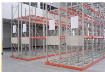
重量ラック(通路幅1.5M)
