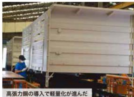
高張力鋼の導入で軽量化が進んだ
