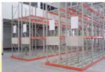
重量ラック（通路幅1.5M）
