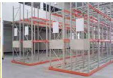
重量ラック(通路幅1.5M)
