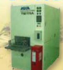
炭化水素真空洗浄機・TETRA TETRA Size: w1065xd2235xh1970mm
