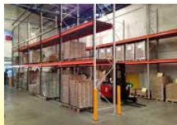
重量ラック(通路幅3M)
