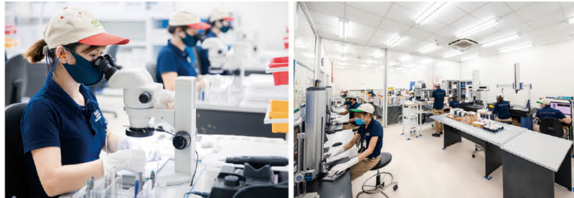
工場内ではバリ取り作業と合わせて人の目によるチェックを行う。3次元測定器と画像測定器（QV202）などによる品質管理も万全。二重、三重の検査によって品質の安定化を図っている
