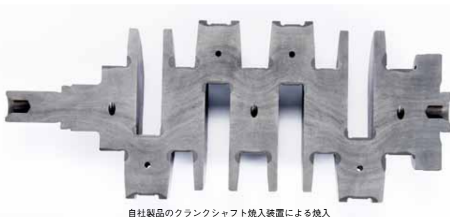
自社製品のクランクシャフト焼入装置による焼入
