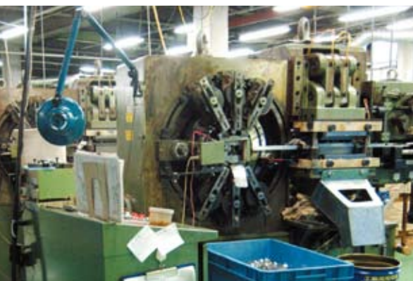
自社製作金型によるマルチフォーミング加工。
