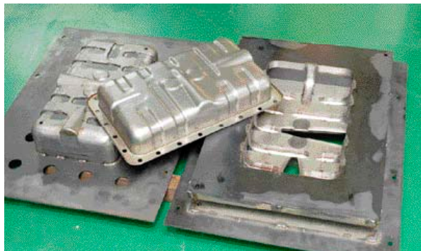
積層金型による絞り加工。
