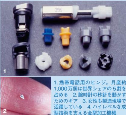
1. 携帯電話用のヒンジ。月産約1,000万個は世界シェアの5割を占める 2. 腕時計の秒針を動かすためのギア 3. 女性も製造現場で活躍している 4. ハイレベルな成型技術を支える金型加工機械
