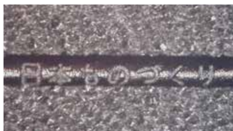
髪の毛(φ0.08)への加工 使用工具径(φ0.01)
