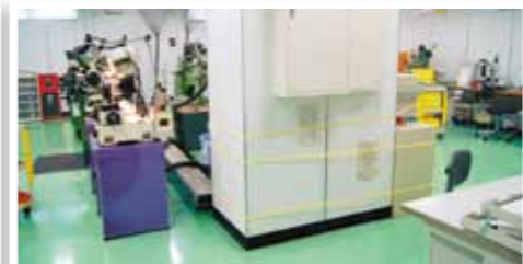
揺れによる位置ズレが起こらないように、設備類は黄色いテープ等で幾重にも固定されている。
