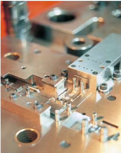
試作から量産順送まで対応する高精度金型。
